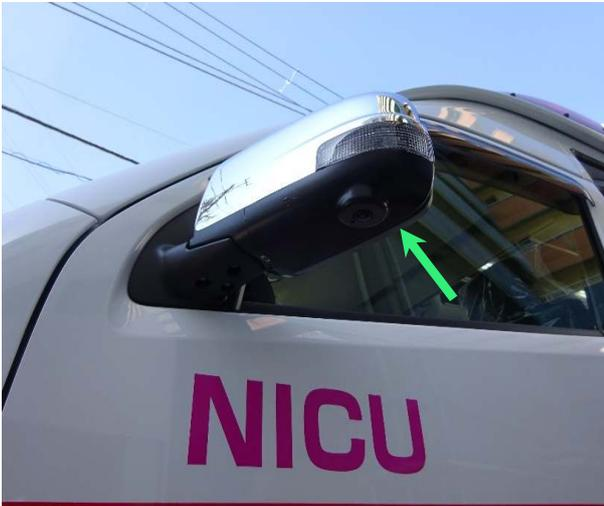
アラウンドビューモニターの側面カメラは、ドアミラー下に装着されています。
